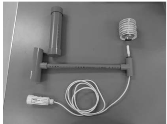
図2. 自作した日射シールド (右上) と温湿度センサー．センサーにつながっている左下部分はデータロガー部.
